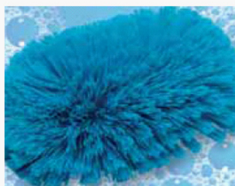
Vlákna jsou slepená po dlouhém používání. Náčiní by mělo být vyměněno.
